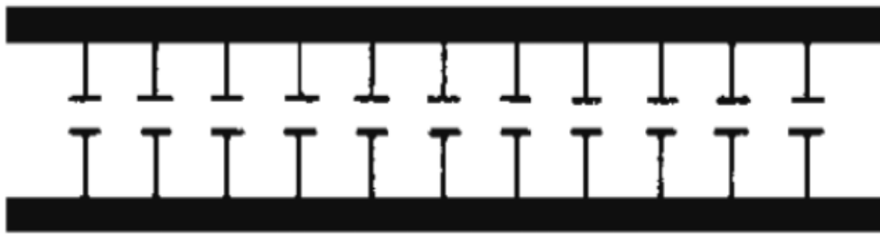
आकृती 3.9 ट्रान्समिशन लाइन कॅपेसिटन्स (capacitance)
